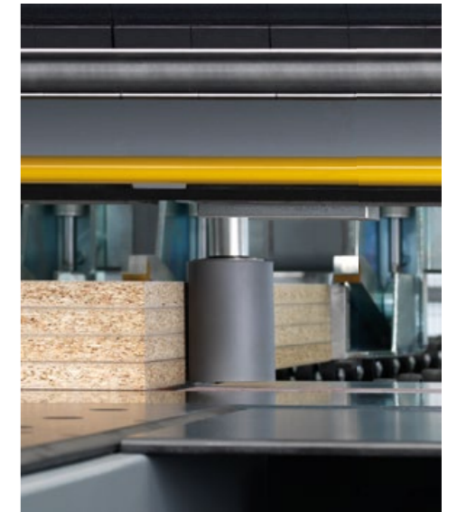
Dispositif de pression angulaire double performance –pour un positionnement précis et sans compromis contre le guide d'équerrage.
