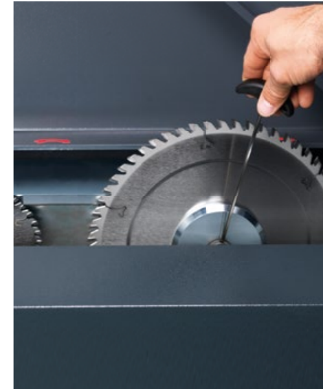
Le système Prolock® EasyFix vous permet de changer de lame de scie en un tournemain.
