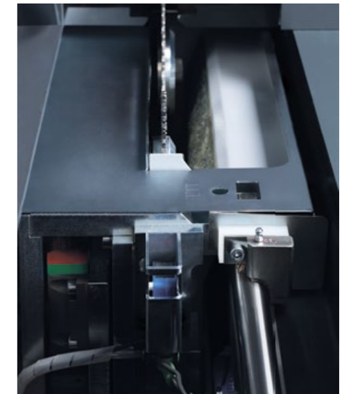
Des guidages du chariot de sciage sophistiqués et résistants à l'usure garantissent un angle de 90° à chaque coupe même après des années d'utilisation en service permanent dans l'industrie.
