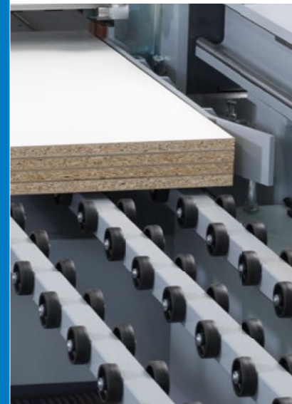
Convoyeurs à rouleaux derrière la table de support pour faciliter la manipulation des panneaux jusqu'à la ligne de coupe.
