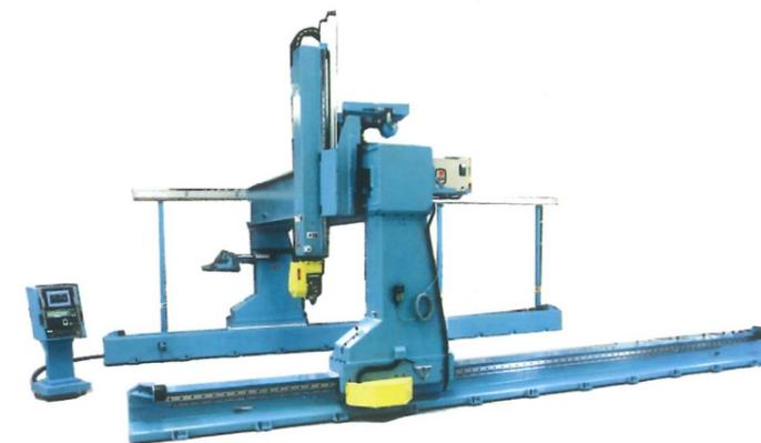
Grazie all'interfaccia software di produzione-CN, si passa rapidamente dal disegno CAD alle fasi operative da eseguire sulla macchina. Un sistema di rilevazioni laser permette di localizzare con precisione la posizione della trave e di iniziare immediatamente la lavorazione.
