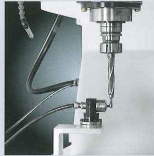
> Sistema di verifica degli utensili per diametro, lunghezza e integrità. Montato a bordo macchina, INTOOL garantisce grande risparmio grazie alla riduzione dei tempi di inattività della macchina, oltre che rilevando misure accurate del diametro e della lunghezza degli utensili e loro eventuali rotture, con relativa riduzione degli scarti.
