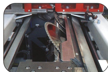
Robustes patentiertes Sägeaggregat mit Schwenkbereich von 0 bis 46°
