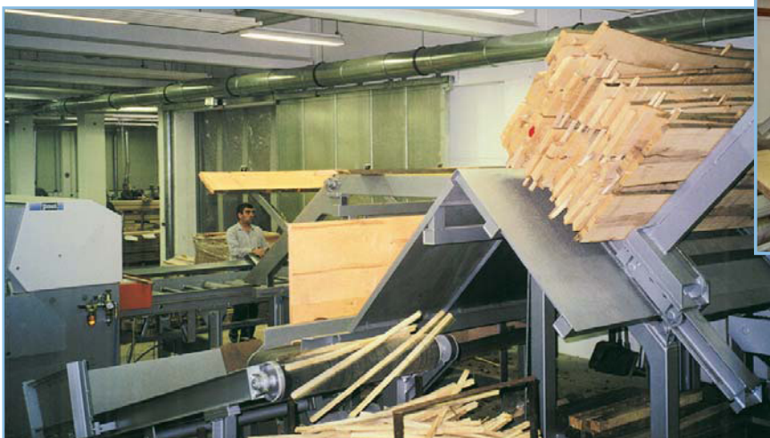
Abb. 4 Automatische Entstapelung, Abtransport der Stapelleisten und Wendevorrichtung
