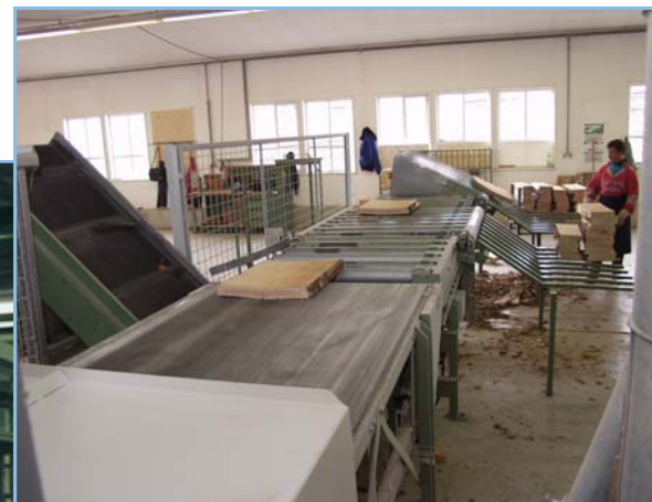
Abb. 10 Abtransport der gekappten Ware und Längensortierung
