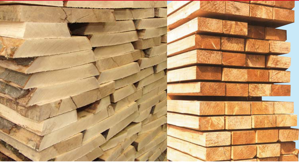
Abb. 1 Besäumtes und unbesäumtes Massivholz mit großen Querschnitten
