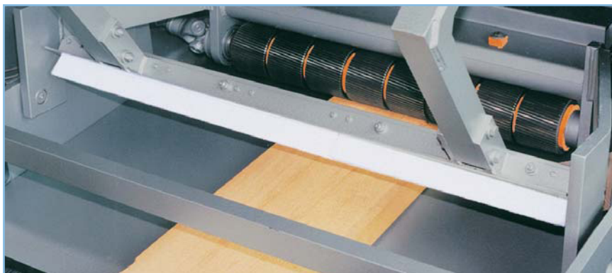
Abb. 3 Innenraum einer Kappanlage 18GE: Segmentierte Oberwalzen, schwenkbarer Besen
