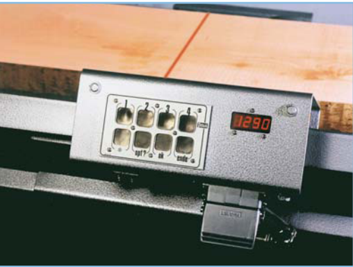
Abb. 9 Messwagen mit robusten Funktionstasten und leuchtendem Display
