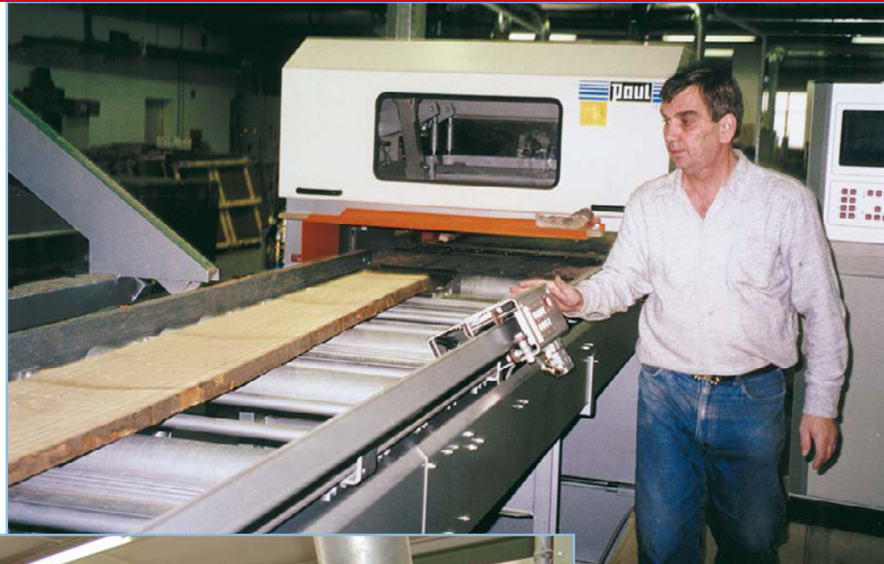
Abb. 6 Verfahrbarer Messwagen zur berührungslosen Schnittstellen- und Fehlermarkierung
