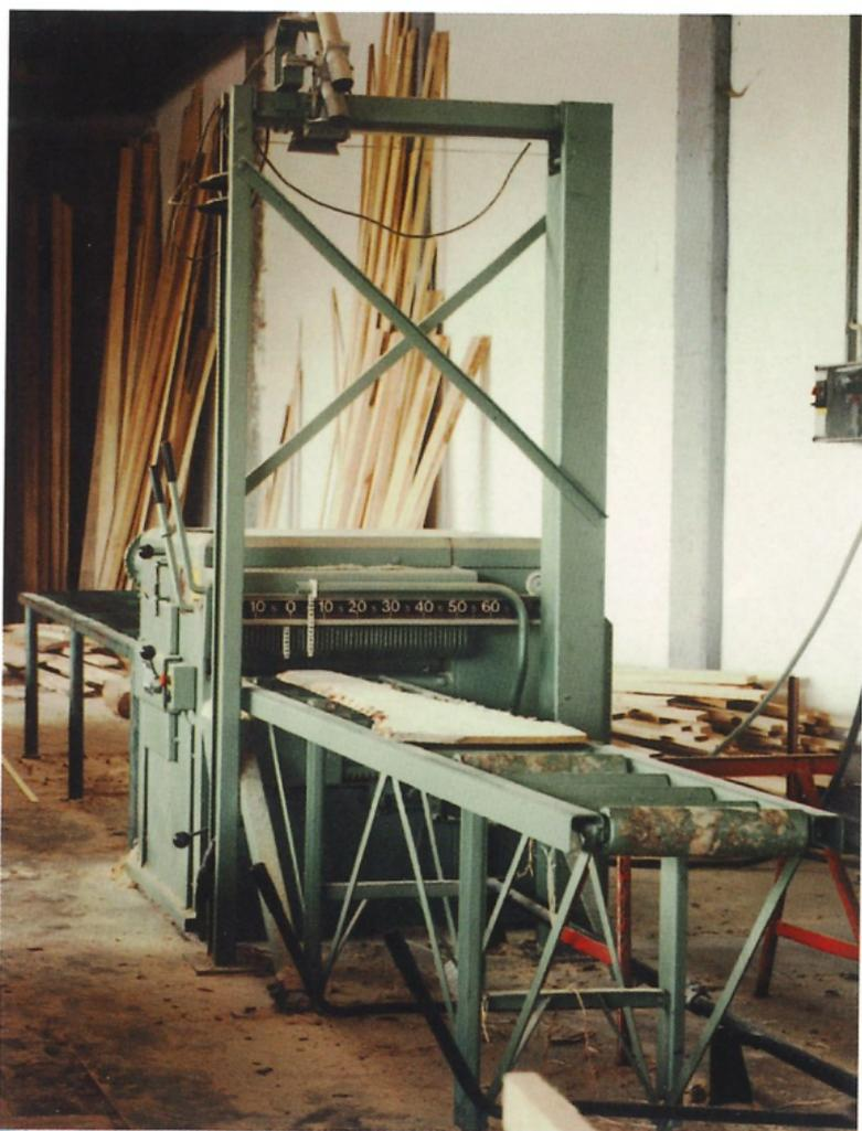
*Doppelbesäum-Kreissäge der Baureihe KME 2 mit Laserrichtlicht*
