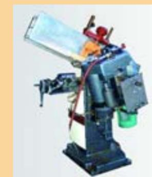
Mortaiseuse spéciale pour réaliser des coupes d'onglets
