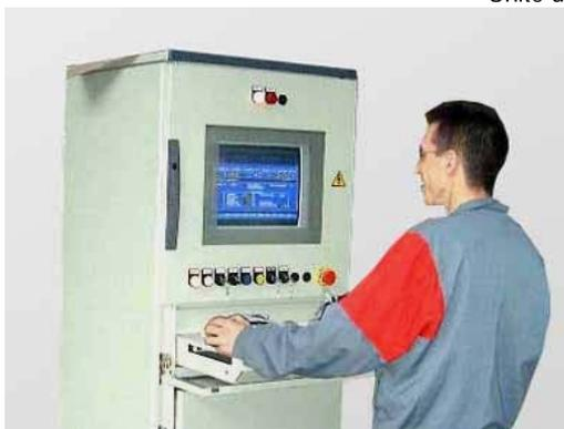
Pilotage de la machine par micro ordinateur sur pupitre
