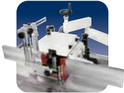
Fränschlag Schnelle Einstellung
