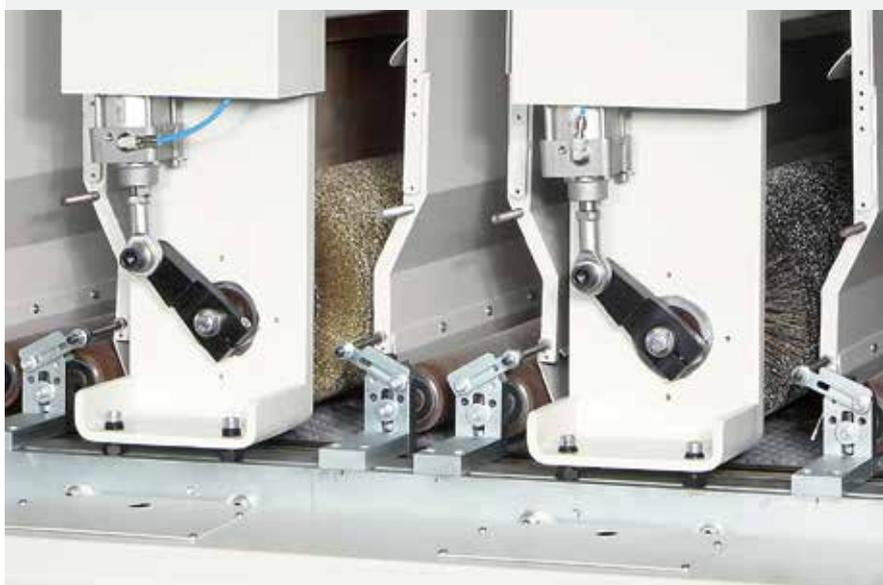
Les **groupes rouleau structureur** permettent d'obtenir des effets de finition allant de la légère ouverture du pore jusqu'à la structuration extrême. Ils assurent des résultats parfaits grâce à la solide structure portante et aux puissances des moteurs disponibles.
