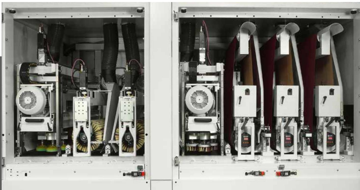
Équipée de 7 groupes d'usinage principaux, la DMC System T7 1350 représente la solution la plus avancée actuellement sur le marché pour l'usinage de fenêtre, assemblée ou en pièces, du calibrage à la super finition, en un seul passage en machine:
