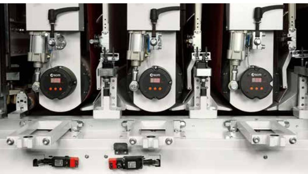
Les rouleaux de contact de DMC System T7 1350 sont équipés de groupes de pression lourds, à structure monobloc et à guides prismatiques de coulissement vertical, pour une précision et une fiabilité maximales au cours de l'usinage de menuiserie et lors de calibrages avec d'importants enlèvements.
