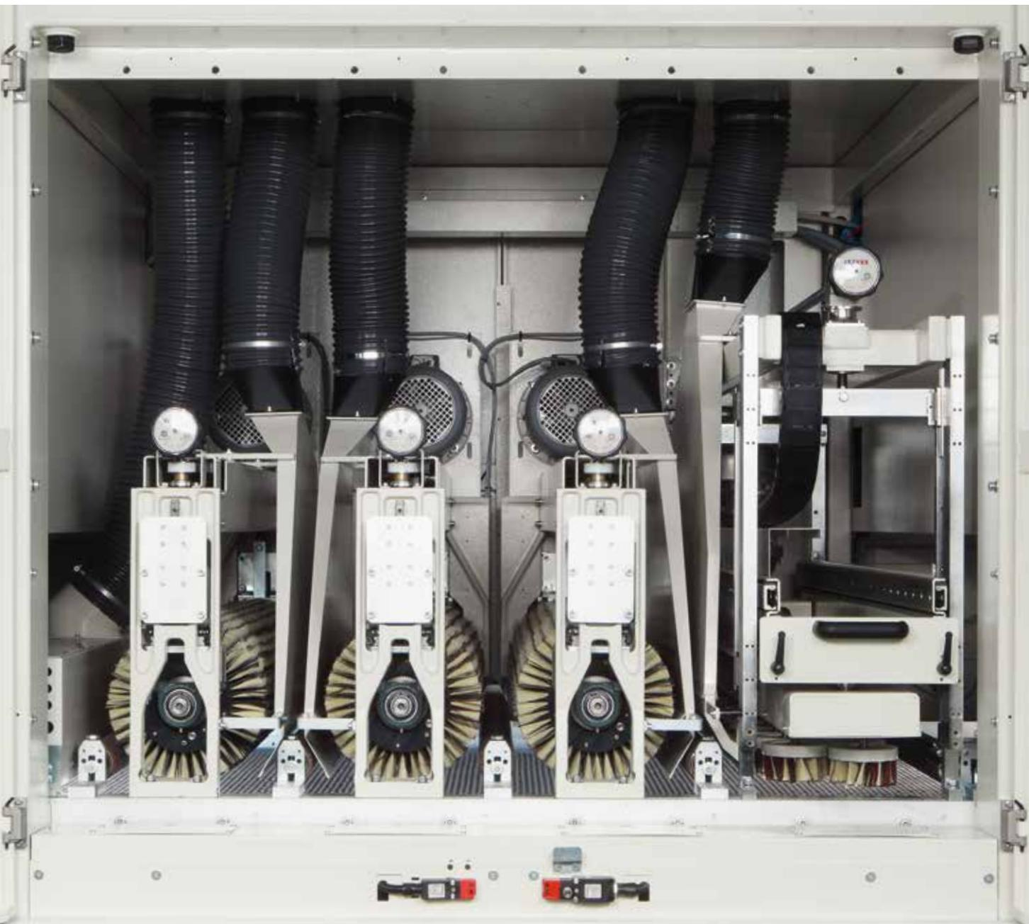
Configuration parfaite pour la finition des battants assemblés, des huisseries et des profilés en général (baguettes de cadres, huisseries, couvre-fils, lambris, plinthes, etc.), aussi bien bruts que vernis.
