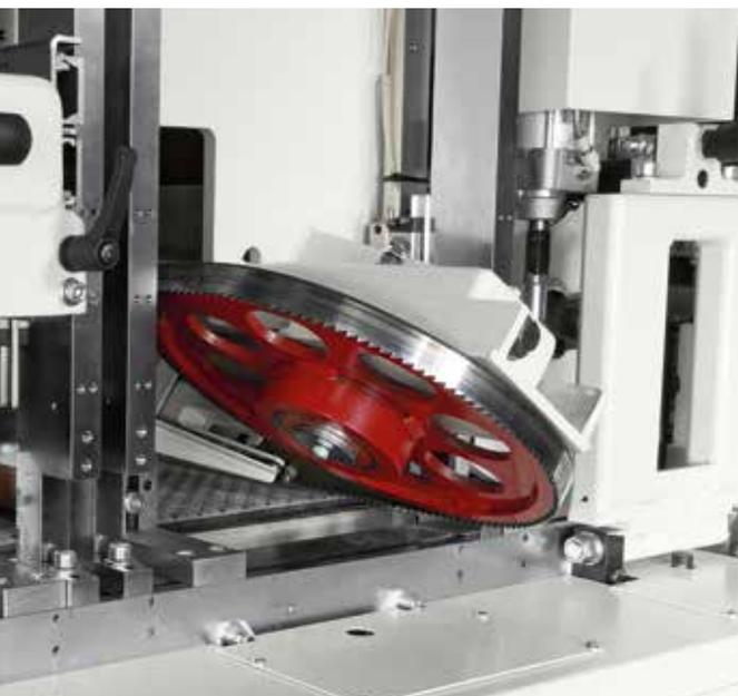
L'innovant **groupe à "lame de scie"** permet d'imiter l'irrégularité superficielle produite par une découpe effectuée avec une scie à ruban. La possibilité de régler la profondeur de la lame et la vitesse de rotation de la lame permet de contrôler la profondeur et la distribution des incisions et donc de définir, au cas par cas, le type d'effet de finition finale souhaité.
