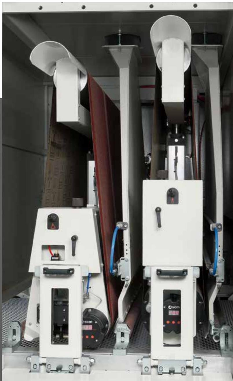
Le nouveau système de blocage rapide des groupes au bâti et l'afficheur numérique de la cote de travail apportent une extrême rapidité et précision dans le réglage de la machine.
