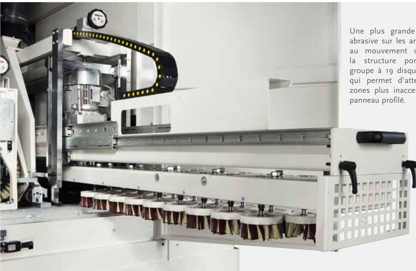
Une plus grande efficacité abrasive sur les arêtes grâce au mouvement orbital de la structure portante du groupe à 19 disques rotatifs qui permet d'atteindre les zones plus inaccessibles du panneau profilé.
