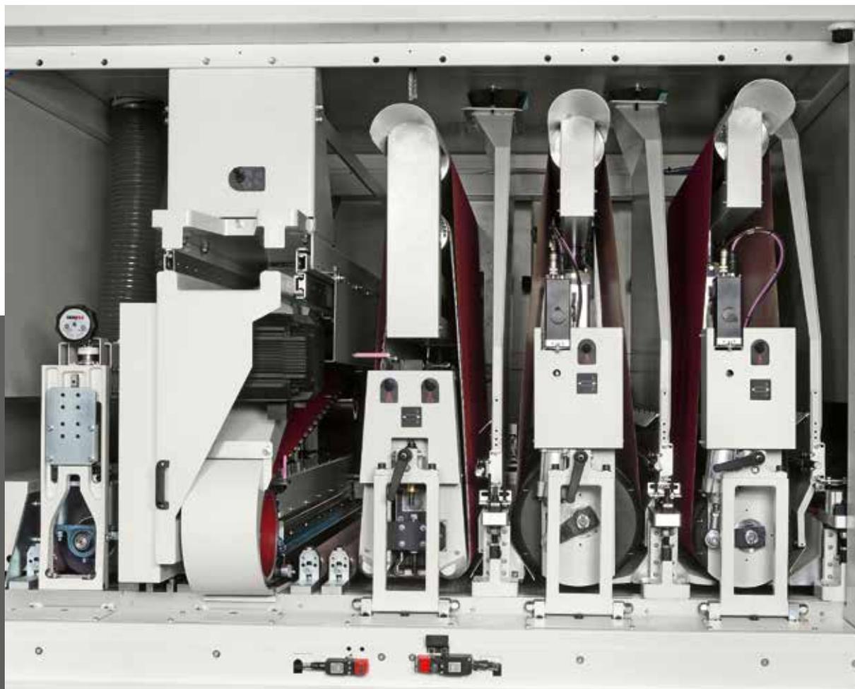
Avec rouleau calibreur, rouleau ponçeur de grand diamètre, patin de super finition, groupe transversal et rouleau en texture abrasive, la configuration de DMC System 1350 T5 illustrée ici répond parfaitement à toutes les demandes de production et de finition de l'entreprise industrielle et du sous-traitant particulièrement exigeant, qui doit inévitablement allier productivité et flexibilité d'utilisation.
