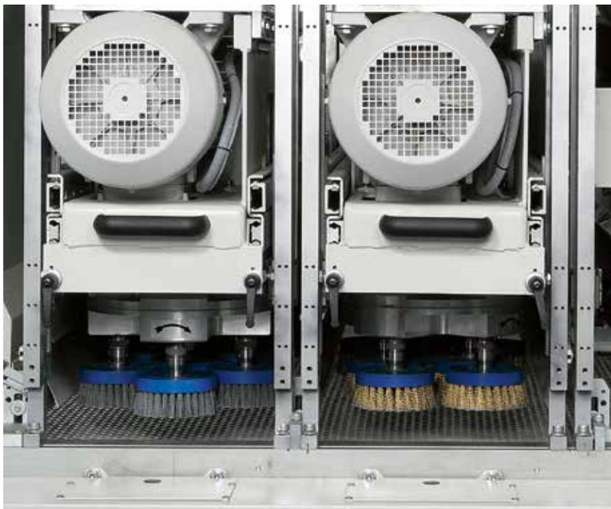
Le ponçage et l'effet structuré sur produits finis avec croisement de la veine comme par exemple pour les meubles ou les menuiseries, s'obtiennent grâce à la multi-directionnalité de l'action abrasive des **groupes planétaires**.
