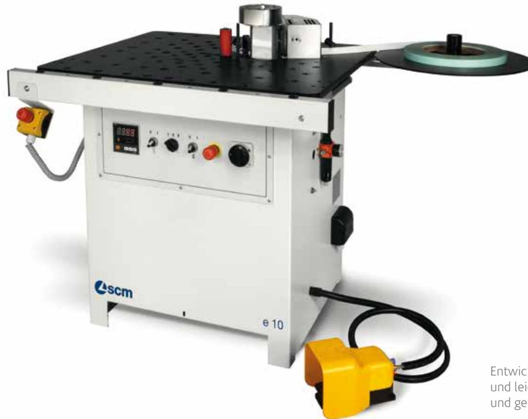
Entwickelt für das kostengünstige, zuverlässige und leichte Anleimen von Kanten an geraden und geformten Werkstücken.
