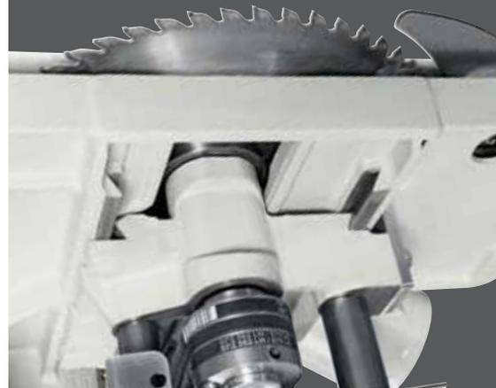
La rotation du corps oscillant s'effectue sur 2 appuis en demi-lune de diamètre 120 mm: une solution rigide et fiable dans le temps.
