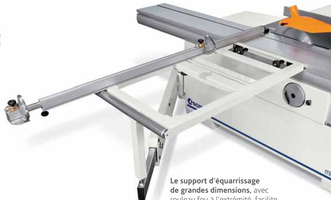
**Le support d'équarrissage de grandes dimensions**, avec rouleau fou à l'extrémité, facilite le chargement des panneaux. La **règle d'équarrissage télescopique avec 2 butées réversibles**, permet d'effectuer l'équarrissage de panneaux 3200 x 3200 mm et d'exécuter des coupes d'angle jusqu'à 45° sur les deux côtés du support.
