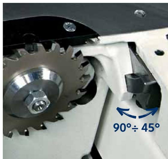
L'inciseur est réglable de l'extérieur, sans besoin de clés, assurant ainsi un positionnement rapide et précis sans jeux.
