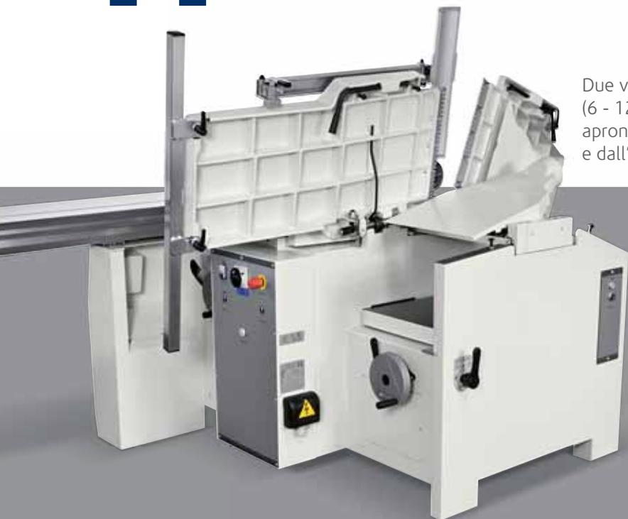
Due velocità di avanzamento allo spessore (6 - 12 m/min.) standard. Nella **cu 410e** i piani a filo si aprono verso il lato sega-toupie: una soluzione ergonomica e dall'ingombro minimo.
