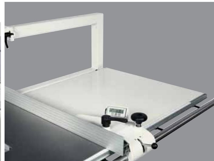
visualizzatore digitale per la lettura della quota sulla guida parallela
