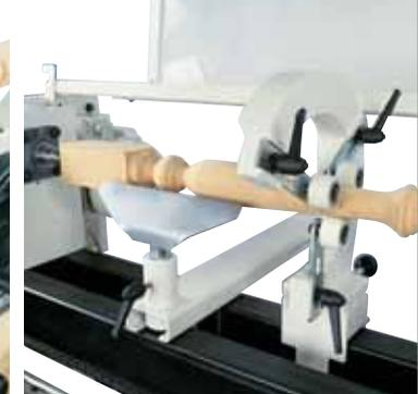
**Lunetta Fissa**, utilizzata per ridurre le vibrazioni di pezzi lunghi e sottili. La configurazione a "C" permette il passaggio di un utensile a mano.
