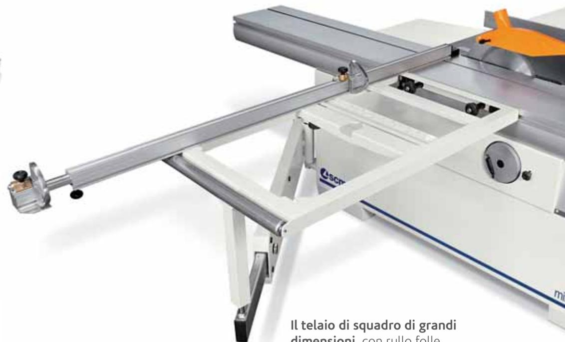
**Il telaio di squadro di grandi dimensioni**, con rullo folle all'estremità, facilita il carico dei pannelli. La **riga di squadro telescopica con 2 battute reversibili**, permette di squadrare pannelli fino a 3200 x 3200 mm e consente anche di effettuare tagli inclinati fino a 45 gradi su entrambi i lati del telaio.
