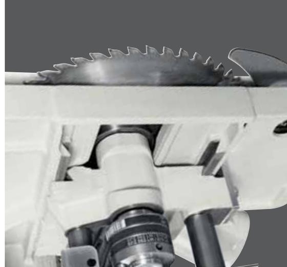
I fulcri di rotazione del corpo oscillante sono di 120 mm di diametro ed appoggiano su due lunette intermedie al basamento: soluzione rigida ed affidabile nel tempo.
