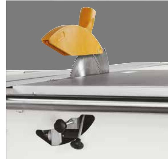
Der Vorritzer mit eigenem Antrieb ist ohne Schlüssel von außen regulierbar und erlaubt schnelle, präzise und spielfreie Positionierungen.
