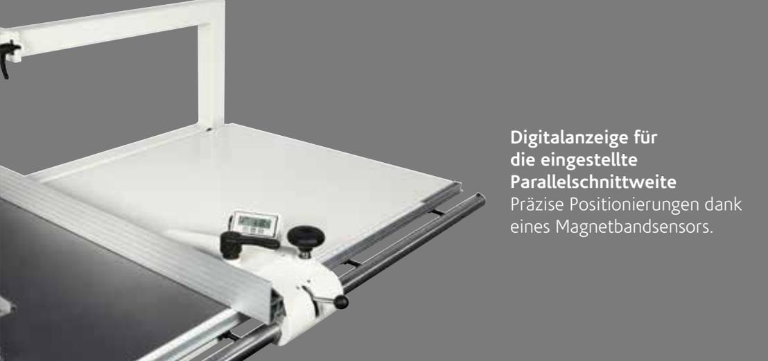
**Digitalanzeige für die eingestellte Parallelschnittweite**
