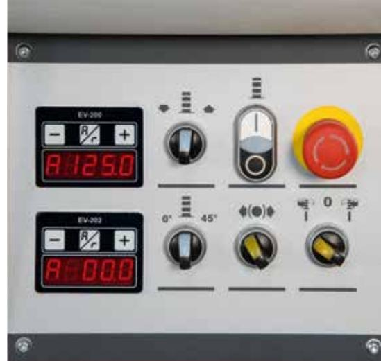
Motorische Verstellung der Arbeitsaggregate mit Digitalanzeige
