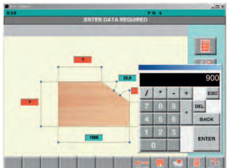
Zusätzliche Berechnungsmodi unterstützen den Bediener bei der Durchführung von Winkelschnitten bei **komplexen geometrischen Formen**: Eine saubere einfache Lösung, um Zeit zu sparen und kostspielige Fehler zu vermeiden. Die Steuerung kann die unbekanntenen Abmessungen und Winkel aufgrund der eingegebenen Werte in Echtzeit errechnen.
