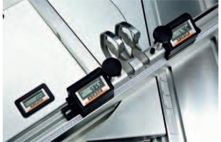
Die digitalen Anzeigen am Längsanschlag und für den Drehwinkel des Besäumrahmens ermöglichen ein schnelles und präzises Ablesen der eingestellten Werte. Das Erfassungssystem über Magnetstreifen ist **staubunaempfindlich** und auf Dauer präzise.
