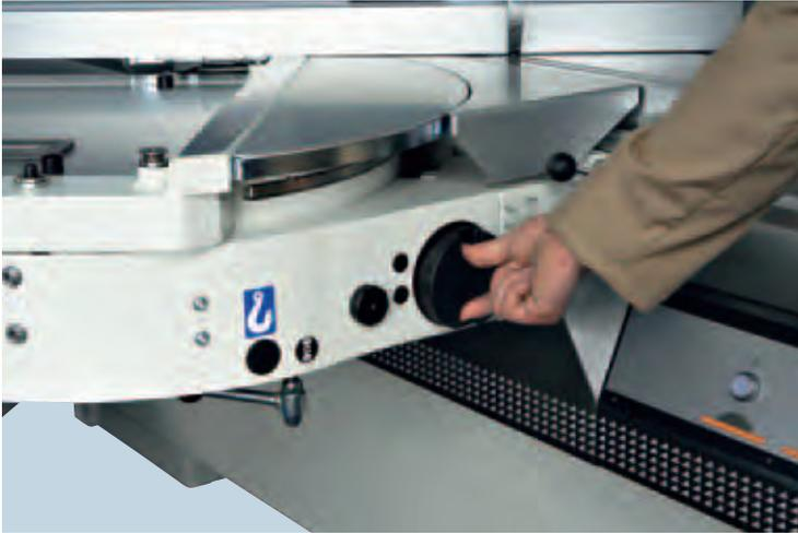
Die **mikrometrische Regulierung** ermöglicht es, den gewünschten Winkel über Handrad schnell und präzise einzustellen.
