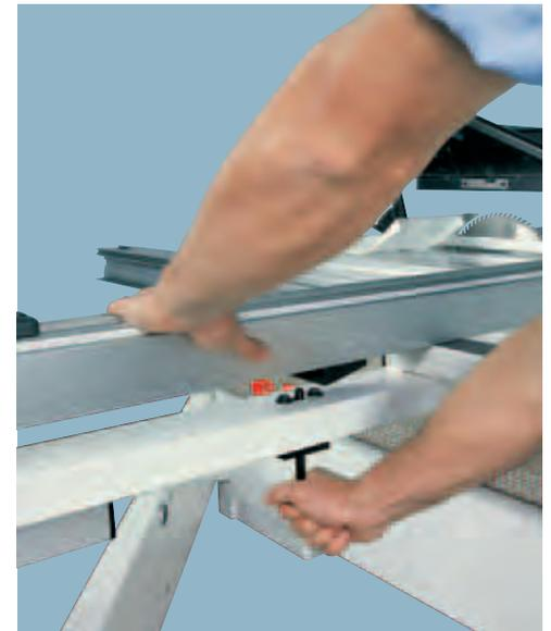
Durch Schieben von kleineren Werkstücken mit dem Längsanschlag in Richtung des Sägeblatts sind die Sicherheitsbedingungen für den Bediener bestmöglich und eine optimale Schnittqualität wird gewährleistet.
