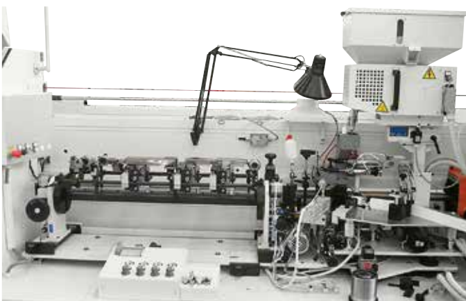
Gruppo incollaggio per la lavorazione di porte con bordi sottili/morbidi.
