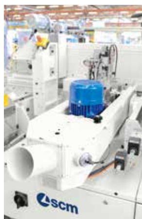
Gruppi levigatori per la finitura della porta bordata con bordo in impiallacciatura.
