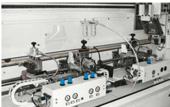
Gruppi per la finitura dell'angolo nelle porte bordate su 3 oppure su 4 lati.
