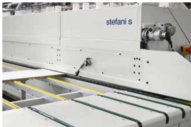
transfer in uscita mono/multicinghia per l'integrazione con automazione a monte ed a valle (opt)
