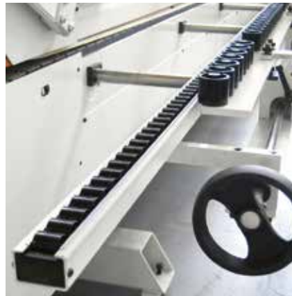
Spalla di contrasto per pannelli stretti, massello o soffforming (opt)
