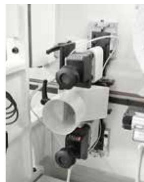
Gruppo raschiafilo per la rimozione del bordo in esubero e per la finitura del profilo.
