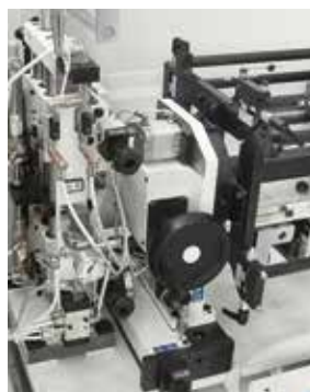
Gruppo cesoia longitudinale per l'incisione del bordo in eccedenza.
