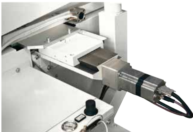
Guida in ingresso manuale (std), pneumatica o ad asse CN (opt)
