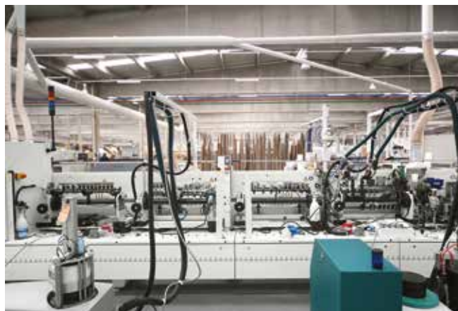
Gruppo incollaggio per softforming con zona di pressione fino a 4.5 m. Ideale per profili di ogni tipologia con spessori bordo maggiori di 0.8 mm e colla EVA/PU.
