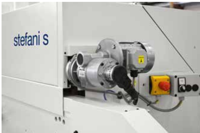
Oberdruck mit NC Steuerung
