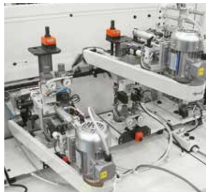
Schleifaggregat für Rundungen/Radien.
