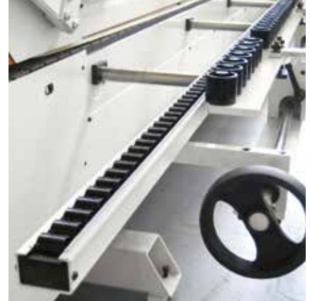
Zusätzliche Druckrollen für Schmalteile, Massivholzkanten oder Softforming
