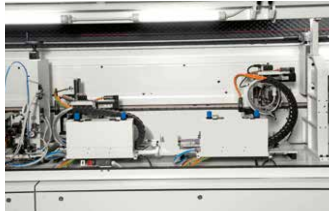
2-MOTORIGES SERVOGESTEUERTES ABRUNDUNGSAGGREGAT
