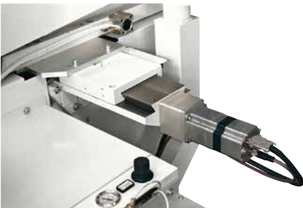
Einschubhilfe, manuell, pneumatisch oder NC gesteuert.
