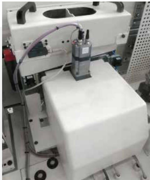
Vertikale NC gesteuerte Werkzeugpositionierung
