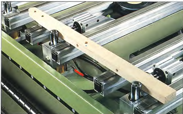
Blockier- und Bearbeitungsbeispiel kleiner Werkstücke für die Stuhlherstellung
