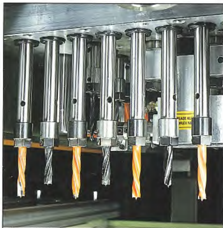
Spindeln für Vertikalbohrung auf der X-Achse (Achsenabstand 32 mm)
