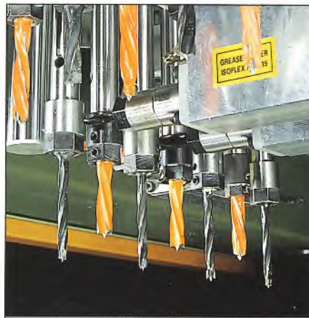
Spindeln für Vertikalbohrung auf der Y-Achse (Achsenabstand 32 mm)
