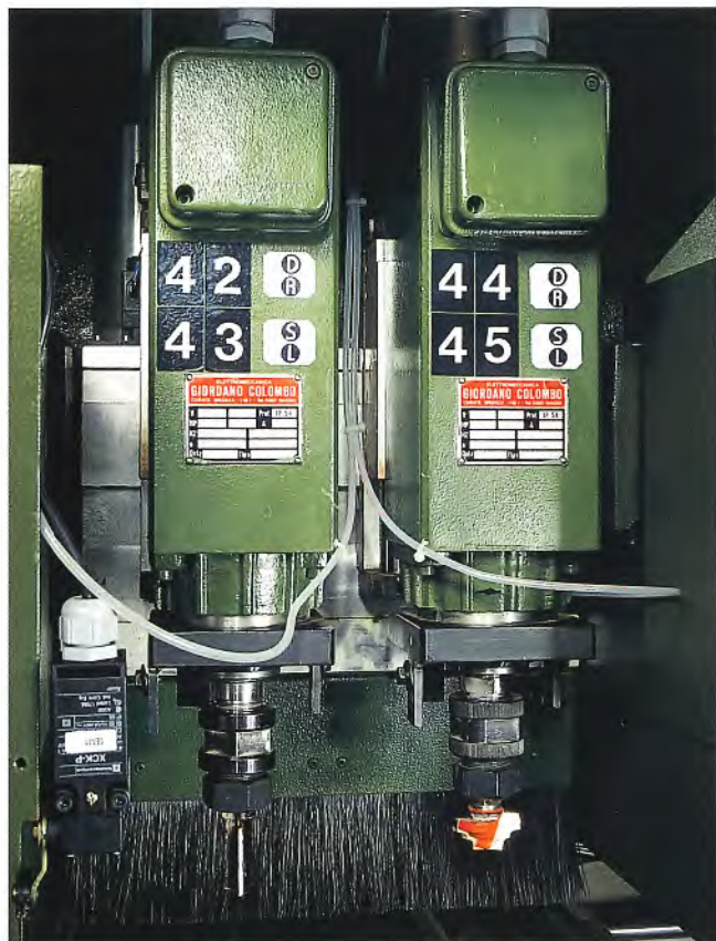
Fräsaggregate mit 7,5 PS / 5,52 kW (Sonderzubehör)
