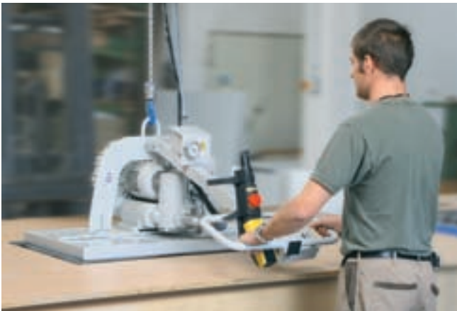
VacuMaster Multi, 400 kg Traglast, horizontal zur Beladung einer Plattenaufteilsäge mit großen Holzplatten
