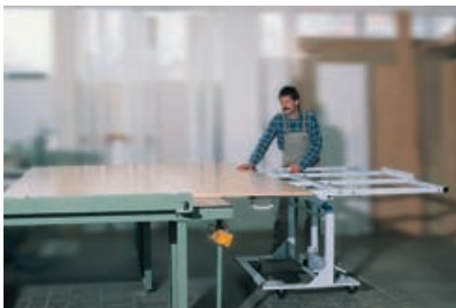
28 Plattentransportwagen PTS 250 zur Beladung von liegenden Sägen
