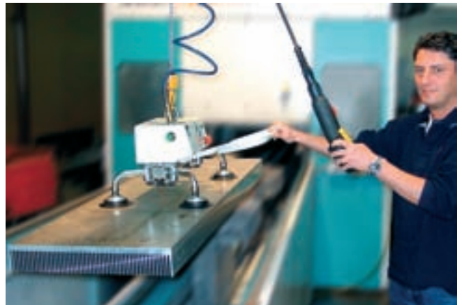
VacuMaster Light, 100 kg Traglast, horizontal zur Be- und Entladung von CNC-Bearbeitungsmaschinen
