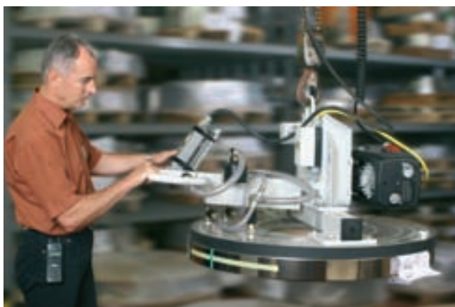
VacuMaster Coil, 750 kg Traglast, horizontal, zur Handhabung von Edelstahl-Coils
