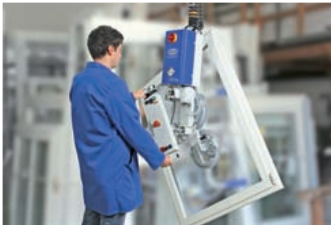
VacuMaster Window Comfort, 170 kg Traglast, vertikal zur Handhabung von mehrflügeligen Fenstern
