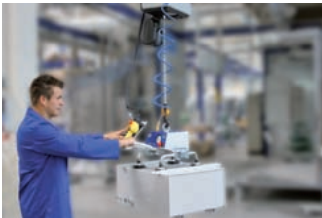
VacuMaster Light, 100 kg Traglast, horizontal zur Handhabung von lackierten Korpusen
