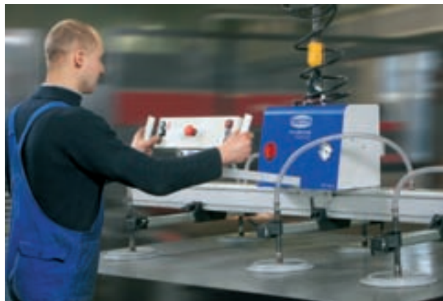
VacuMaster Comfort, 750 kg Traglast, horizontal zur Handhabung von Blechtafeln
