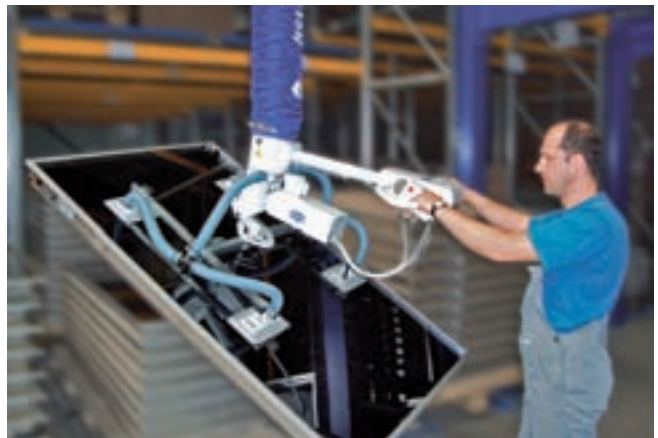
JumboErgo, Traglast 70 kg, mit pneumatischer Schwenkeinheit, zum horizontalen Aufnehmen von Solarmodulen und vertikalen Absetzen auf einen Kommissionierwagen
