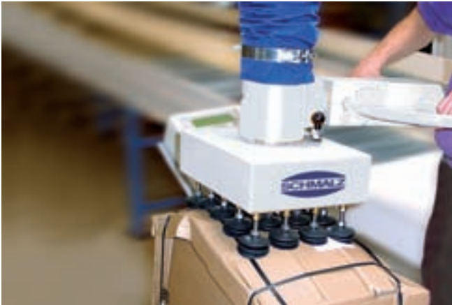
JumboErgo, Traglast 45 kg mit Mehrfachsauggreifer Compact, zur Handhabung von labilen Kartonagen
