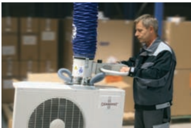
JumboErgo, Traglast 85 kg mit Doppelsauggreifer, zur Handhabung von Klimageräten
