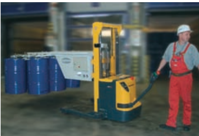
VacuMaster, 140 kg Traglast, zum Transportieren von Fässern von einer LKW-Entlade-stelle zum Förderband
