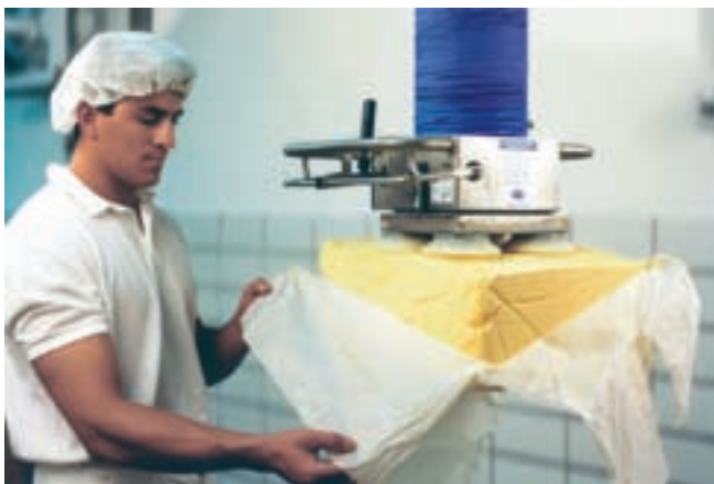
JumboSprint, Traglast 65 kg in Edelstahlausführung, zur Handhabung von Lebensmitteln
