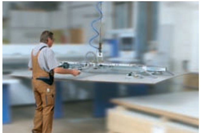
VacuMaster RE, 250 kg Traglast, zur Beladung von Bearbeitungsmaschinen
