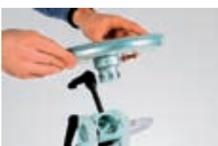
Schneller Austausch der Saugplatten mittels Klemmhebel
