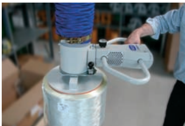
JumboErgo, Traglast 65 kg, zur Handhabung von Folienrollen
