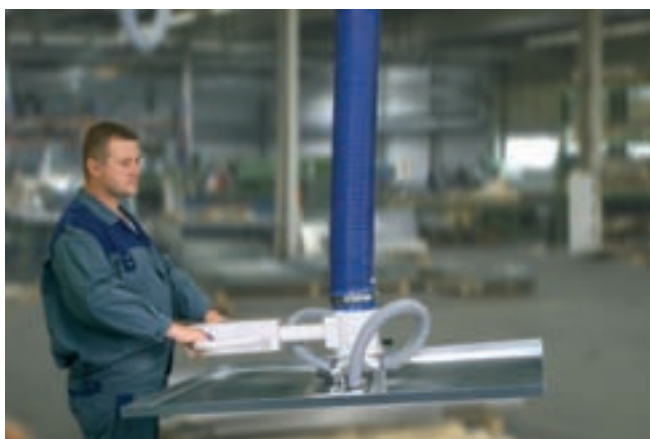
JumboErgo, Traglast 45 kg mit Doppelsauggreifer, zur Beladung von Beklebanlagen
