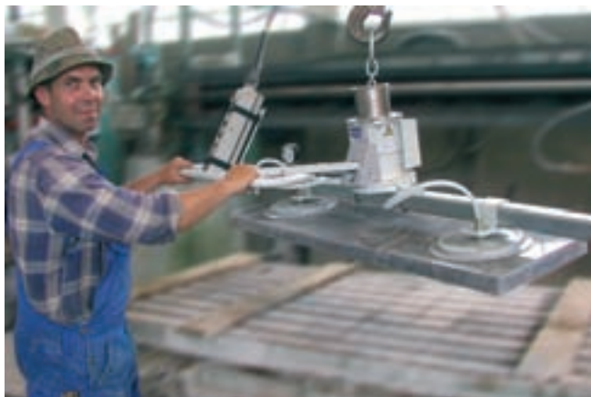
VacuMaster Eco, 250 kg Traglast, horizontal zur Be- und Entladung von Steinbearbei-tungsmaschinen
