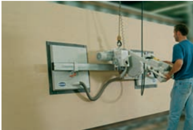
VacuMaster Multi, 300 kg Traglast, vertikal zur Beladung von stehenden Sägen
