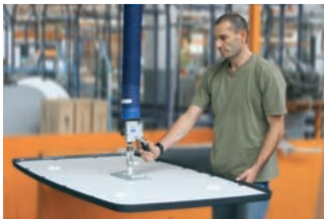
JumboHandy, Traglast 30 kg mit Einzelsauggreifer, zur Kommissionierung von Campingtischen
