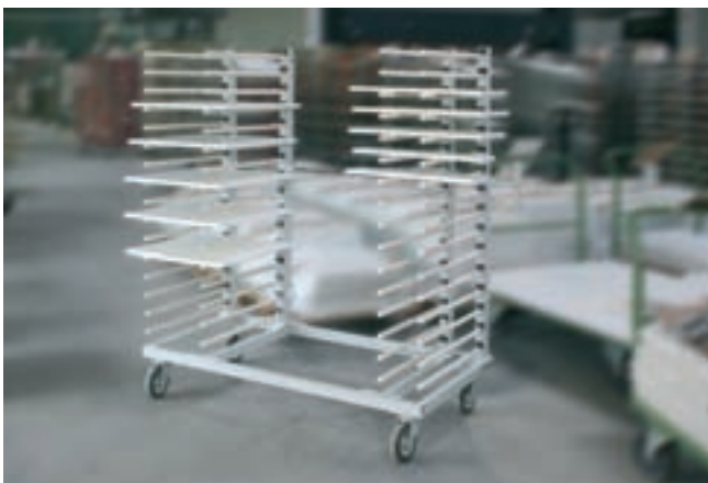
Hordenwagen HWV zum Ablegen und Transportieren von Werkstücken
