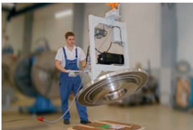
VacuMaster Coil, 750 kg Traglast, 90° schwenkbar, zur Handhabung von Coils
