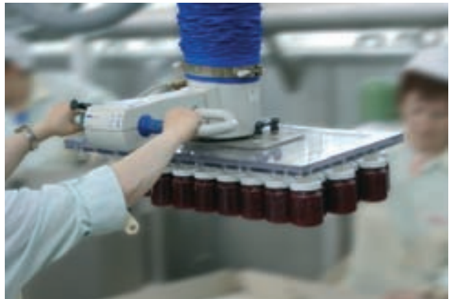
JumboErgo, Traglast 85 kg zur Handhabung von 48 Konfitüregläsern
