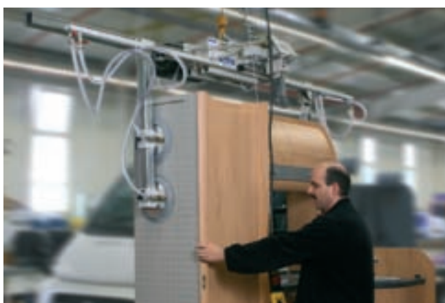
VacuMaster Box, 200 kg Traglast, zur Montage von Küchenelementen im Wohnmobilbau
