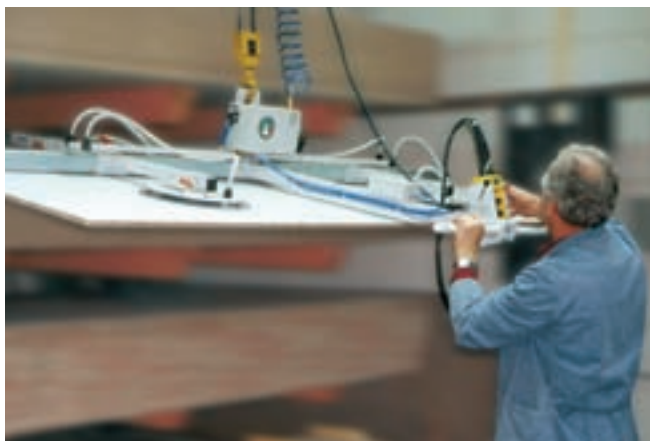
VacuMaster RE, 250 kg Traglast, horizontal zur Entnahme von Holzplatten aus Kragarmregalen und anschließenden Beladung von CNC-Holzbearbeitungszentren
