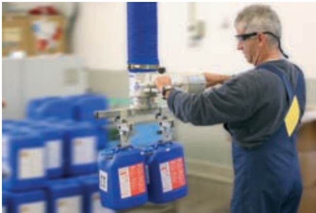
JumboErgo, Traglast 45 kg, zum Abstapeln von Kanistern am Rollenband
