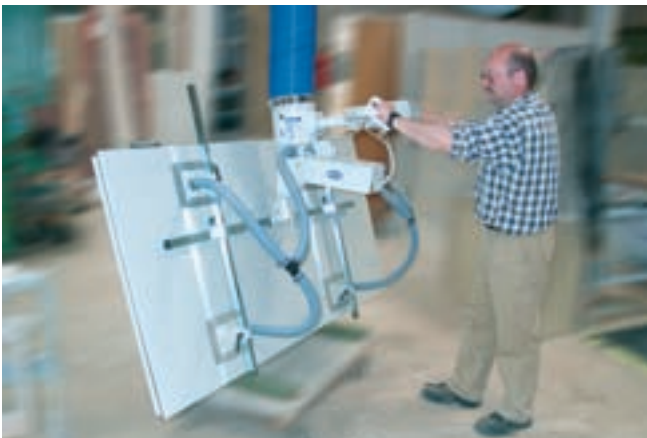
JumboErgo, 90 kg Traglast mit pneumatischer Schwenkeinheit und Vierfachsauggreifer, zum Handhaben von Holzplatten
