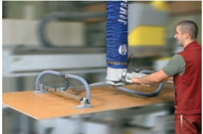
JumboErgo, Traglast 85 kg mit Vierfachsauggreifer, zur Be- und Entladung von CNC-Holzbearbeitungsmaschinen
