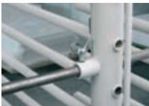
Hordenwagen HWV mit stufenlos verstellbarem Rechen
