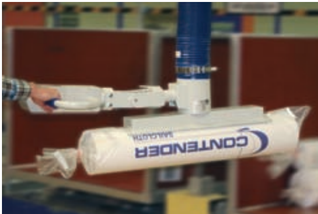
JumboErgo, Traglast 45 kg, zur Kommissionierung von in Folien verpackten Textilrollen
