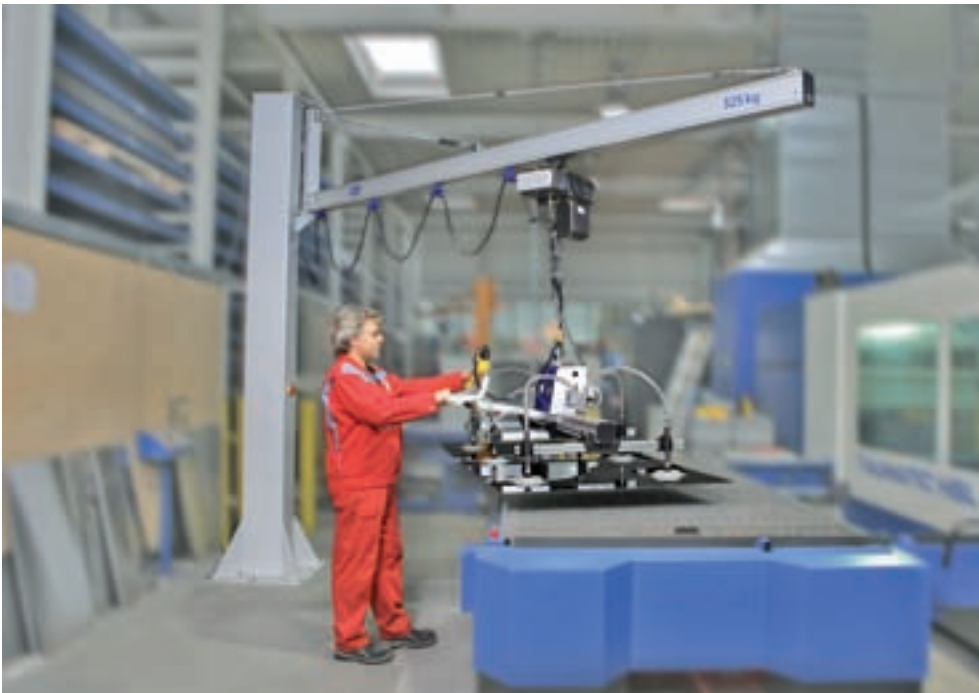
VacuMaster Basic, 250 kg Traglast, horizontal zur Handhabung von Edelstahlblechen
