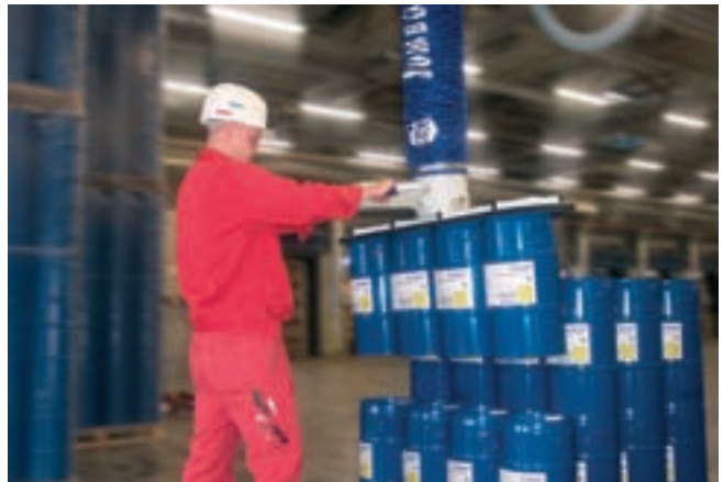
JumboErgo, Traglast 140 kg, zur gleichzeitigen Handhabung von 4 Fässern
