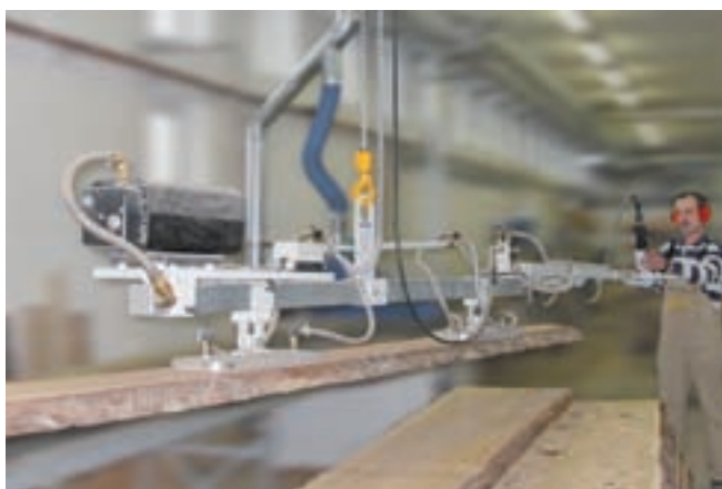
VacuMaster VHB, 500 kg Traglast, zur Handhabung von sägerauen Bohlen
