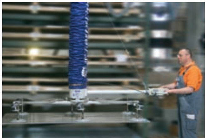
JumboErgo, Traglast 140 kg zur Kommissionierung von mittel- und kleinformatigen Aluminiumblechen
