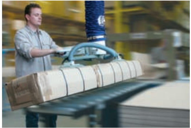
JumboErgo, Traglast 85 kg mit Doppelsauggreifer, zur Handhabung von bis zu 4 m langen Kartonagen
