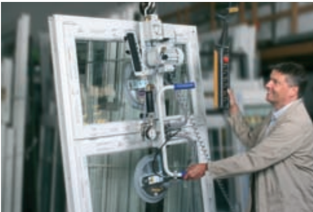
VacuMaster Window, 170 kg Traglast, vertikal zur Handhabung von mehrflügeligen Fenstern
