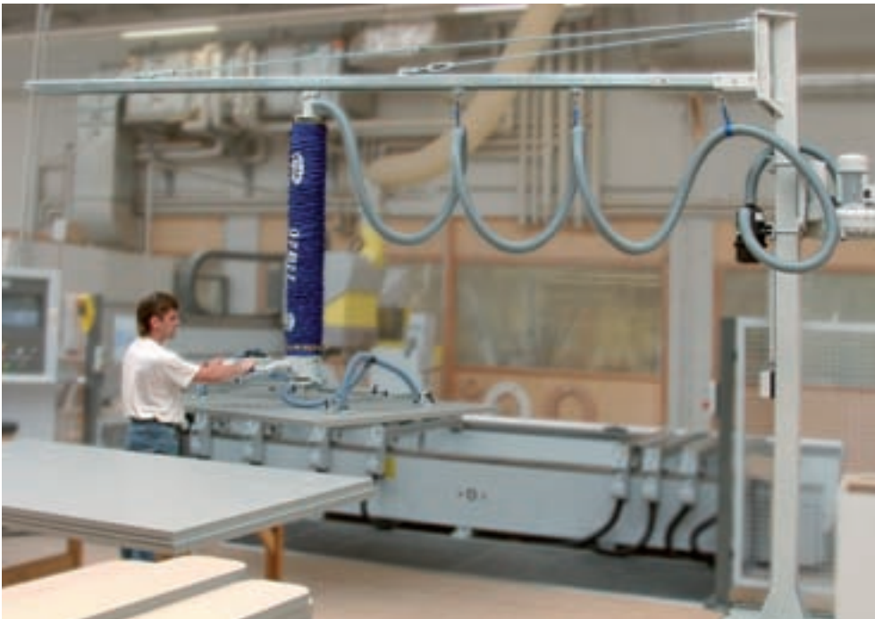
JumboErgo, 85 kg Traglast mit Vierfachsauggreifer zur Be- und Entladung von CNC Holz-Bearbeitungszentren
