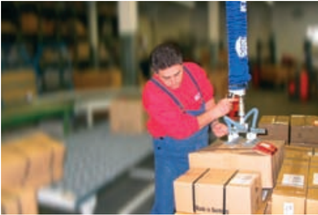
JumboHandy, Traglast 30 kg mit Doppelsauggreifer, zur Handhabung von Kartonagen
