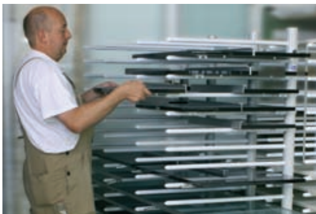
Hordenwagen HW zum Ablegen und Transportieren von Werkstücken
