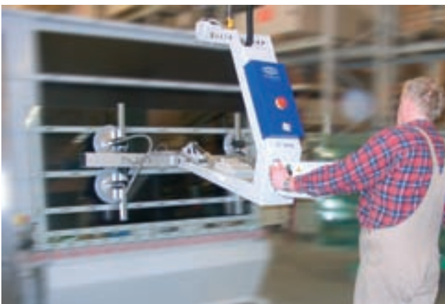
VacuMaster Comfort, 125 kg Traglast, 180° wendbar zur Handhabung von Glasscheiben
