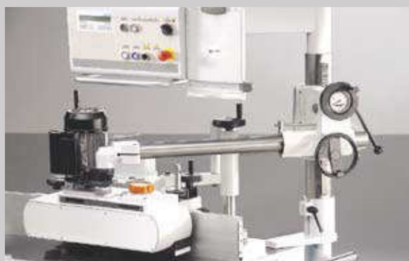
Optional: Supporto per trascinatore applicato al montante del quadro pensile • Feeder support mounted on the upright of the overhanging board • Support pour entraîneur applicable au panneau sur potence • Soporte para alimentador aplicable a el mando pensil.
