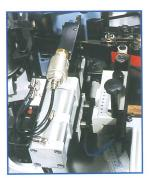
Die Rollentrennschere ist mit einem eigens dafür vorgesehenen Vorschubsystem ausgestattet, um auch bei dicken Kanten und schnellen Vorschubgeschwindigkeiten einen perfekten Trennschnitt zu gewährleisten.
