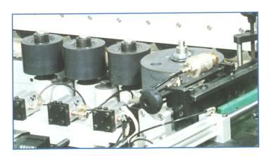
Die **Druckrollen** wurden mit Antihaftmaterial behandelt und sind mit unabhängigen, pneumatischen Verstellungen ausgestattet. Damit wird das Kantenaufleimen optimiert.
