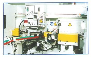
Das Leimbecken ist mit automatischem Ausschluß von der Arbeitslinie ausgestattet und mit einem schnelllösenden System, um das Auswechseln im Fall von Reinigungsarbeiten oder der Verwendung eines Klebers mit anderen Farben zu erleichtern
