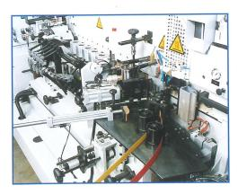
Bei der Softforming-Version des HM-Aufleimaggregats können je nach auszuführender Profilart, Druckzonen unterschiedlicher Länge verwendet werden: Die Höhe der Auftragwalze ermöglicht die Anwendung von Kanten mit beachtlicher Höhe, bis zu 110 mm, hierdurch ist die Ausführung von sehr komplexen und tiefen Softformingprofilen möglich.
