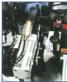
La cisaille est munie d'un système approprié de translation pour garantir la coupe du chant même en cas de fortes épaisseurs ou de vitesses d'avancement élevées.
