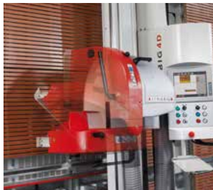
Eine der zahlreichen Funktionen der Striebig 4D: die automatische Motorschwenkung. Sie unterstützt den vollautomatischen Sägeablauf und erleichtert dem Bediener die Arbeit enorm.
