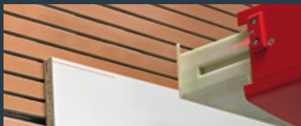
Laser gestützte Anzeige des horizontalen Schnittes (serienmässig)
