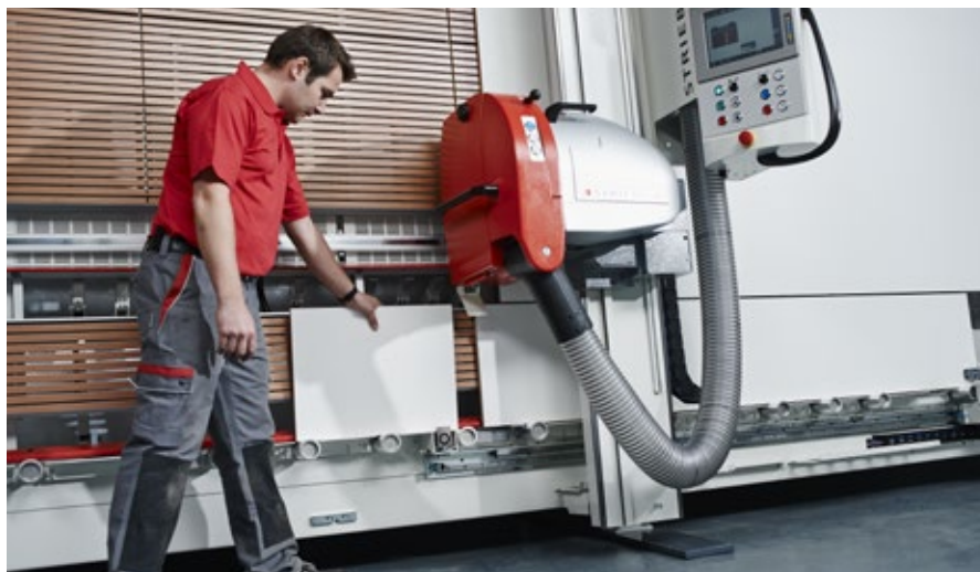
Eine der zahlreichen Funktionen der Striebig 4D: die automatische Motorschwenkung. Sie unterstützt den vollautomatischen Sägeablauf und erleichtert dem Bediener die Arbeit enorm.
