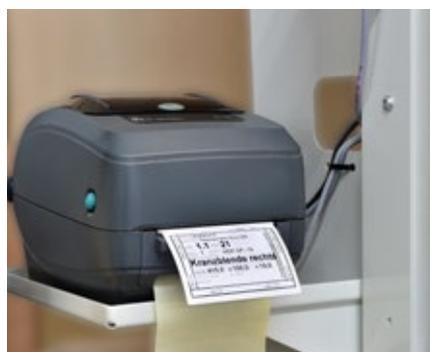
Positionnée directement sur la scie, l'imprimante à étiquettes est entièrement intégrée dans le logiciel.
