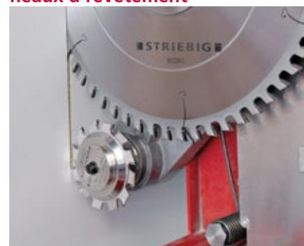
Le VSA est un must pour les quantités assez élevées, pour des panneaux d'un niveau de qualité éventuellement moindre et pour les panneaux en bois massif revêtus d'un placage.
