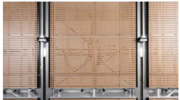
Avec une unité d'abaissement des panneaux supplémentaire (en option), il est possible de traiter des panneaux allant jusqu'à 5000x2150mm et pesant jusqu'à 240kg (80kg/unité PA).
