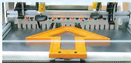
Battuta per quadri a 45°. Fence for 45 degree frames. Gehrungs-Anschlag 45°. Butée pour cadres à 45°. Tope para cuadros de 45°. Dispositivo para furar a 45°.
