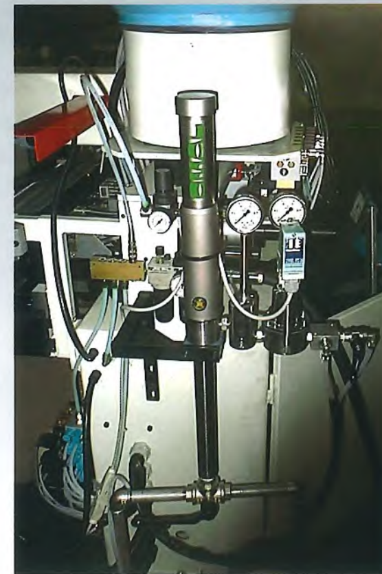
Sistema di alta pressione per alimentazione colla. Highpressure glue pump device. Hochdruck System für die Zuführung des Leims. Système haute pression pour alimentation de colle. Sistema alimentación de cola con bomba alta presión. Sistema alimentação de cola com bomba alta pressão.
