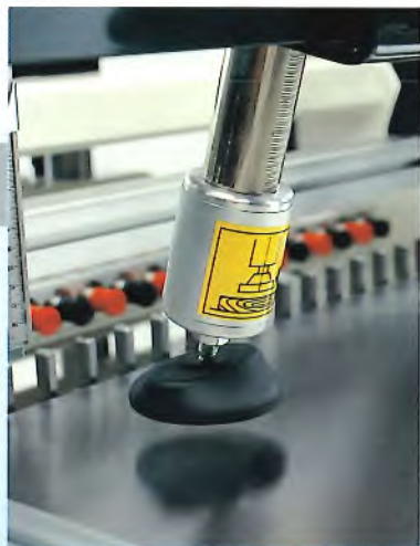
Pressore inclinato 4°. Clamps system 4°. 4° Spannzylinder. Presseurs a 4°. Prensoseres a 4°. Prensadores a 4°.
