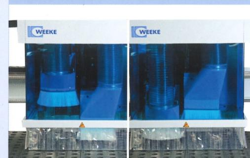
Effiziente Absaugung - die Bearbeitungseinheiten (Fräser oder Bohrgetriebe) werden separat abgesaugt
