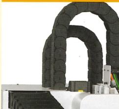
conducción de cables segura y protegida (X-Y-Z)
