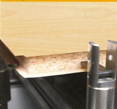
fácil posicionamiento para materiales con sobresaliente de chapa
