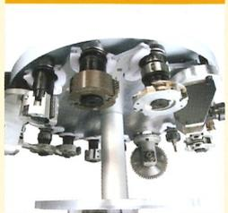
cambiador de herramientas de 14 puestos, acompañante en la dirección X
