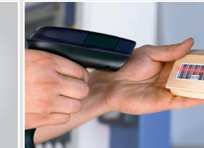
Werkstückerkennung mit Barcode-label
