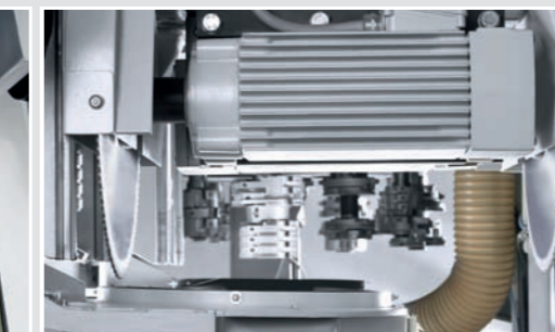
Sägeaggregat zum Ablängen in der Maschine
