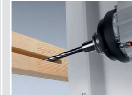
Horizontales Fräsaggregat für große Ausfräsungen, wie z.B. Schlosskasten
