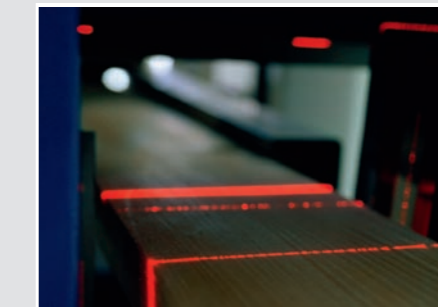
Prozessicherheit durch Rohteilmessung und Kollisionsüberwachung
