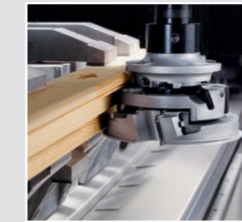
Power satt: Hauptspindel mit bis zu 30 kW
