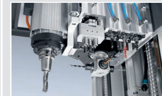
Kombination Mehrspindelbohrkopf horizontal/vertikal mit vertikalem Fräser
