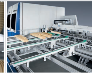
Ein- und Auslaufautomatisierung für "Mannarme" Fertigung
