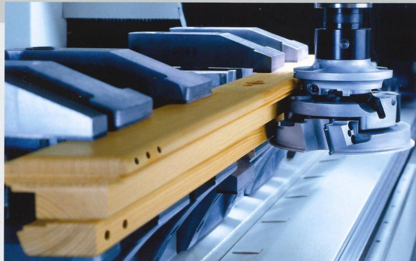
Bei der Werkstückübergabe gewährleistet **PowerGrip** – der patentierte Zangentisch – durchgehende Präzision durch exaktes, schonendes Klemmen des Werkstückes. Das bringt sensationelle Fertigungsvorteile: vorrichtungsfreies und sicheres Arbeiten, absolute Positioniergenauigkeit und damit höchste Qualität. Auch für kleine Teile!
