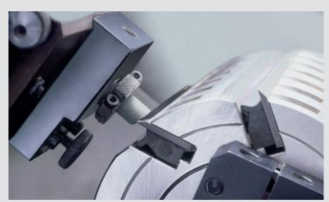
Ferngesteuerter, vollautomatischer Profiljointer mit automatischer Jointstein-Zustellung.
