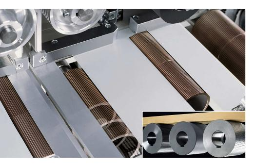
Cada calidad de madera exige un tratamiento específico. La OptiCut 200 permite el cambio de rodillos con rapidez adaptándose a las exigencias. La madera rústica y cepillada se procesa rapidamente y sin dificultad en el mismo turno. Rodillos con resina pueden ser limpiados fácilmente, garantizando la mayor capacidad en cada turno.
