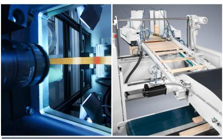
El Weinig sistema de Scanner registra en forma automática y rápida los defectos de la madera, como ser los nudos, grietas y defectos de contorno y provee los datos de optimizacion a velocidad de producción para hasta 4 sierras OptiCut respaldado por una mecanización inteligente.
