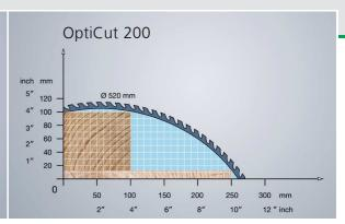
Atención: para determinar la sección transversal hav que considerar alabeos y dimensiones variables de madera. ¡Son válidas las secciones transversales nominales indicadas en los datos técnicos!
