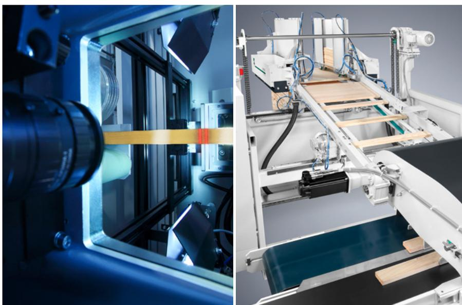
**Les systèmes scanner de WEINIG** détectent à grande vitesse et de façon entièrement automatique les caractéristiques des pièces comme les nœuds, fentes et variations de structure et peuvent asservir au maximum à 4 tronçonneuses haute performance OptiCut les données pour le débit, ceci en pleine vitesse de production et via des mécanisations adaptées.
