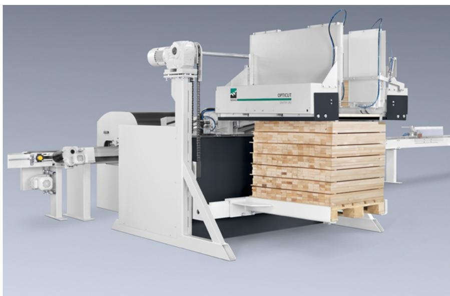
**L'OptiCut Stacker** est la solution idéale quand on produit des longueurs utiles. Celles-ci sont empilées de manière entièrement automatique, atteignant une hauteur de pile de 1200 mm et une cadence jusqu'à 80 pièces / min. Différents types de piles peuvent aussi être sélectionnés dans la commande de la scie.
