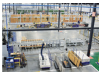
Production de murs fermés Blueprint Robotics, États-Unis
