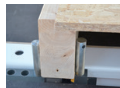
Les unités de serrage pour caissons facilitent l'insertion et le maintien des chevrons et des solives.
