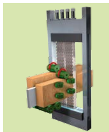
Центральный упор с раздельными прижимными роликами
