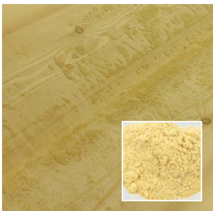
Staubanfall mit Standardsäge
