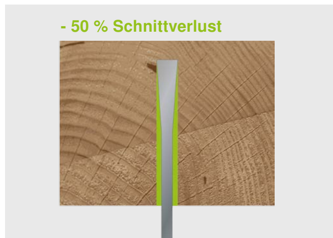
Hochqualitativer Dünnschnitt mit dünnster Schnittfuge und hoher Präzision
