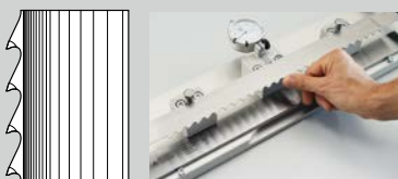
Bereich mit erhöhter Spannung
