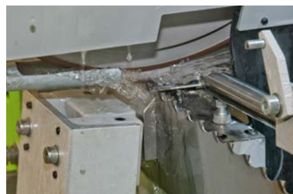
Disco abrasivo, refrigeração da lâmina
