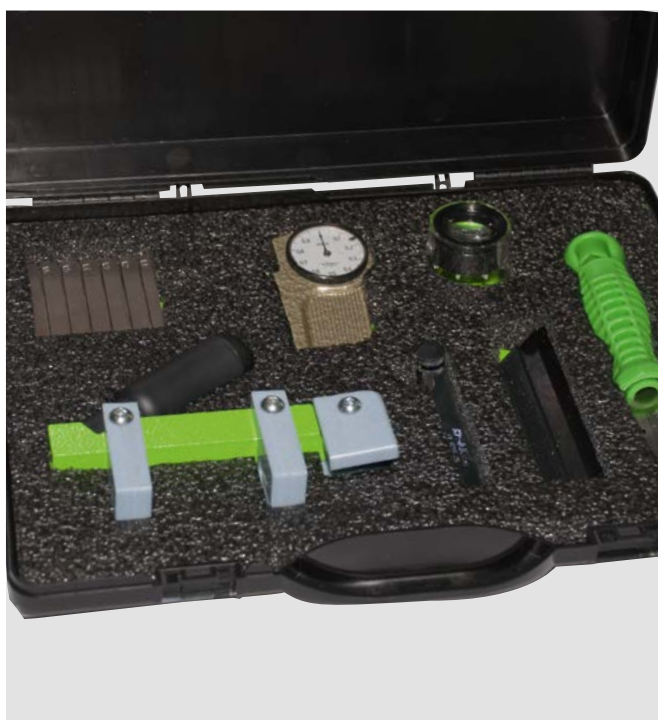
Шаблон для контроля величины развода зубьев
